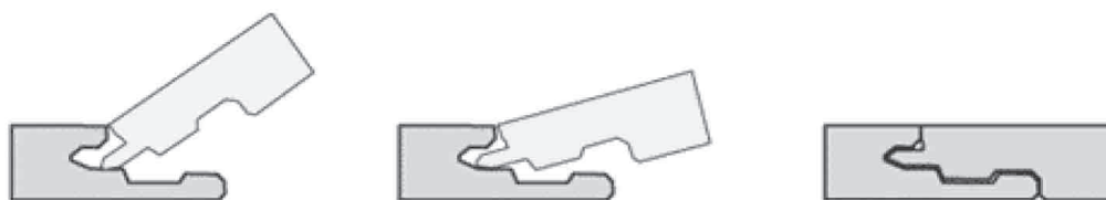
2. Mechanický zámok Woodlock používaný na spájanie podlahových lamiel rozoberateľným click-systémom
