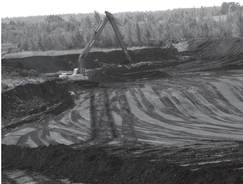
Obr. 1. Klasická těžba uhelných kalů z odkališť, Odkaliště Dolu ČSM (2006). Foto: Miluše Hlavatá
