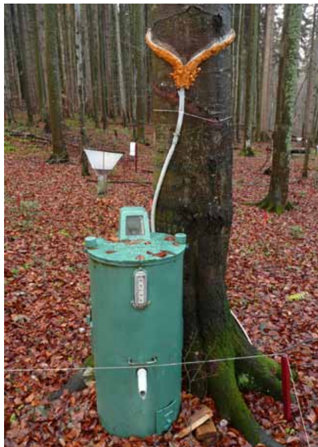
Obr. 3. Záchytné zariadenie na stok zrážkovej vody po kmeni na trvalej monitorovacej ploche Poľana-Hukavský grúň (2013). Foto: Vladimír Čaboun
