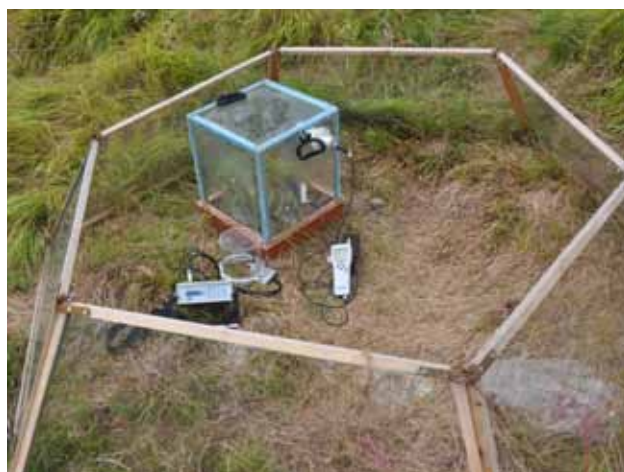
Obr. 5. Experiment na zvýšenie prízemnej teploty so zariadením na meranie tokov CO 2 na výskumnej ploche pri Vyšných Hágoch (2014). Foto: Peter Fleischer
