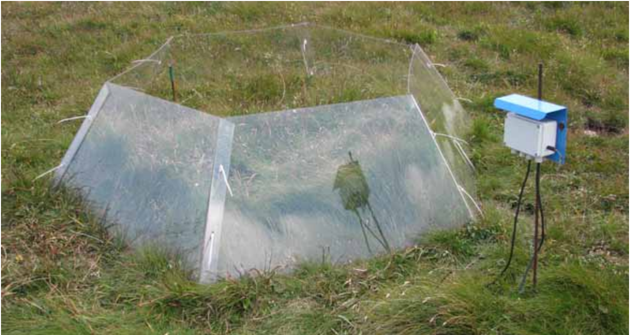
Obr. 1. Simulácia zvýšenia teploty na výskumnej lokalite Kráľova hoľa (blok A) pomocou tzv. zhora otvorených komôr – OTC (2010). Foto: Ľuboš Halada
