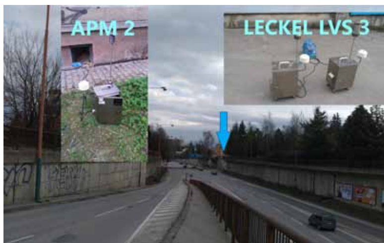
Obr. 5. Meracie stanovište v intraviláne Žiliny na Mostnej ulici: APM 2 – monitor znečistenia ovzdušia tuhými časticami a Leckel LVS 3 – nízkoobjemový vzorkovač (apríl, 2015). Foto: Dušan Jandačka
